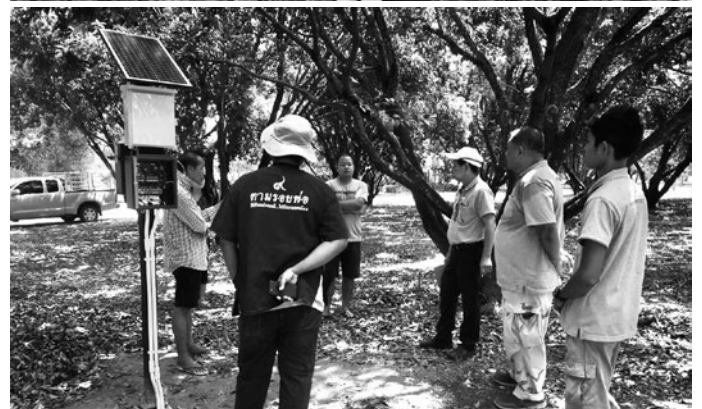
เครื่องวัดค่าความชื้นในอากาศ ในดิน เครื่องวัดอุณหภูมิอากาศและดิน พร้อมเซ็นเซอร์วัดแสงในทรงพุ่มมะยงชิด
